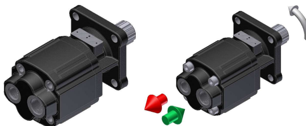
10°- Přešroubujte zadní šrouby . Utahovací moment 80Nm.
